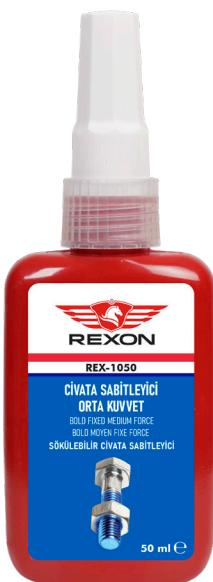
**TR** Orta kuvvet Anaerobik sabitleyici Yüksek mukavemette sökülmmez civata, vida saplama sabitleyicisidir. Sökülmemesi ve gevşememesi istenen civata motor bloklar titreşimli konveyör bantları ve genel tüm ekipmanlarının montajında civata, vida ve saplamaları sabitleme için kullanılır.
